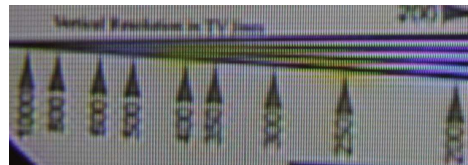
Obrázok 2 – Meranie vertikálneho rozlíšenia 650 HTVL senzora. Všimnite si falošný farebný šum v celom vzore a limit rozlíšenia menej ako 360 VTVL.
